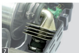
7 Tuyaux de ventilation et refroidisseurs
